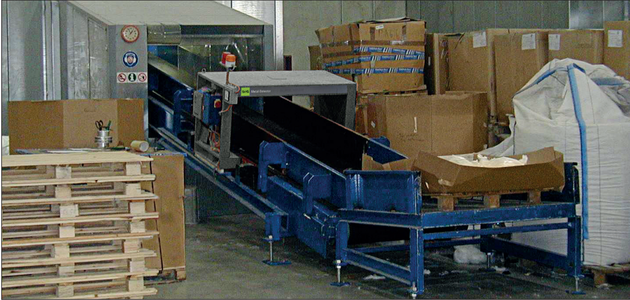
Ví dụ lắp đặt: Máy dò kim loại trong đường ống DLS phân tách các nguyên liệu tái chế trước khi tạo hạt. (phiên bản cũ)
