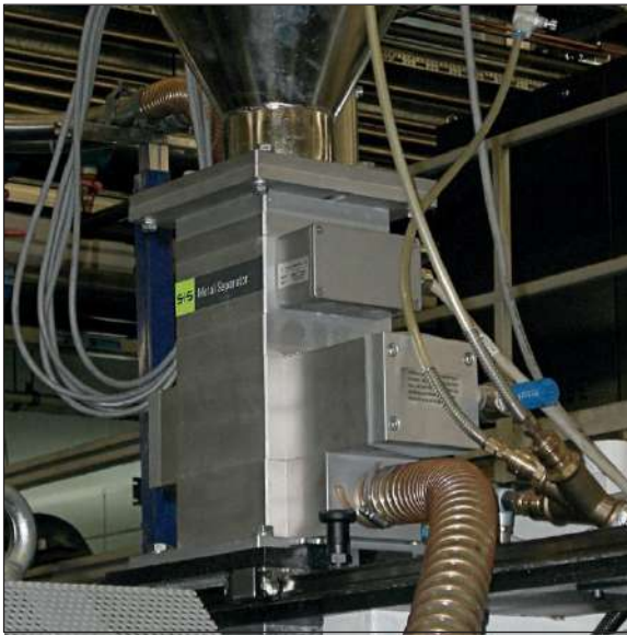
Minh họa lắp đặt: Máy tách kim loại PROTECTOR cài đặt trên bộ cấp liệu của một máy đúc (phiên bản cũ)
