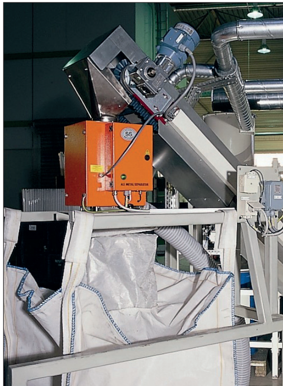
Máy tách kim loại RAPID COMPACT được sử dụng cho việc kiểm soát chất lượng hạt nhựa
