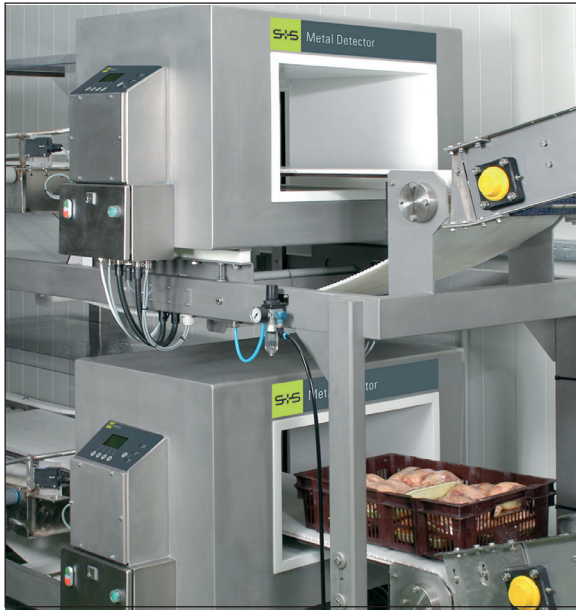
Máy dò kim loại GLS lắp đặt trong hai dây chuyền sản xuất để kiểm tra gia cầm.
